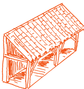
Toit en appentis
